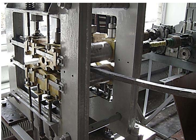
Рис. 2. Общий вид экспериментальной установки 5 \times 100 \times 250 ДГМА, моделирующей процесс правки непрерывнолитых заготовок на участке ТПУ МНЛЗ
